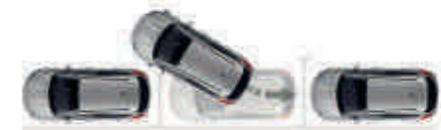
**Auspark-Assistent\*** Ähnlich wie der Einpark-Assistent manövriert Sie dieses System aus einem Parkplatz parallel zur Fahrtrichtung heraus. Das System steuert das Lenkrad, während Sie das Gas- und Bremspedal betätigen. Wenn Sie die Parklücke verlassen haben, übergibt das System mit einer Meldung „Lenkung übernehmen“ die Kontrolle über die Lenkung an Sie. (\*Wunschausstattung)
