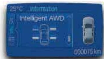
Eine Anzeige im Bordcomputer zeigt die Kraftverteilung zwischen allen vier Rädern an (serienmäßig bei Modellen mit Allradantrieb).
