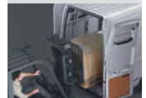
Doppelflügelhecktüren Maximaler Öffnungswinkel 180° serienmäßig (Großraumkastenwagen: 255°)
