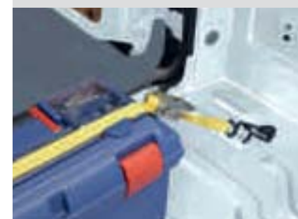
Verzurrösen nach DIN 75410 (Standard)
